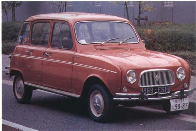
デビュー直後の最高級グレードだったシュペール。外観では2本のパイプを用いたバンパーで他車種と区別している。フロントバンパーは前ヒンジのボンネットを開けた場合を考慮し、下のパイプが曲がっている。
