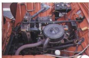
ギヤボックスが一番前にくるパワートレインの配置がよくわかるエンジンルーム。前住着4CVと同じ3ペアリングのOHV型。排気量は747cc、5ペアリングのエンジンを積む最終型のGTLでは、ラジエターが前方に移動する。
