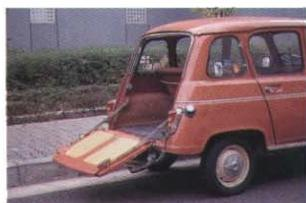
シュペール最大の特徴と言えるのがこのリヤゲート。ワインガードを下に降ろし、その下のヒンジのゲートを開くという手法を取る。バンパーも別のヒンジで下に倒れる点に注目。凝った造りだ。
