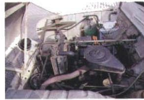
エンジンは先に紹介したパリジェンヌと同じ845ccの3ペアリングOHV。透明なビンを用いた冷却水のリザーバータンクも同じだが、その左のジャッキはバタタグラフィティに変更されている。
